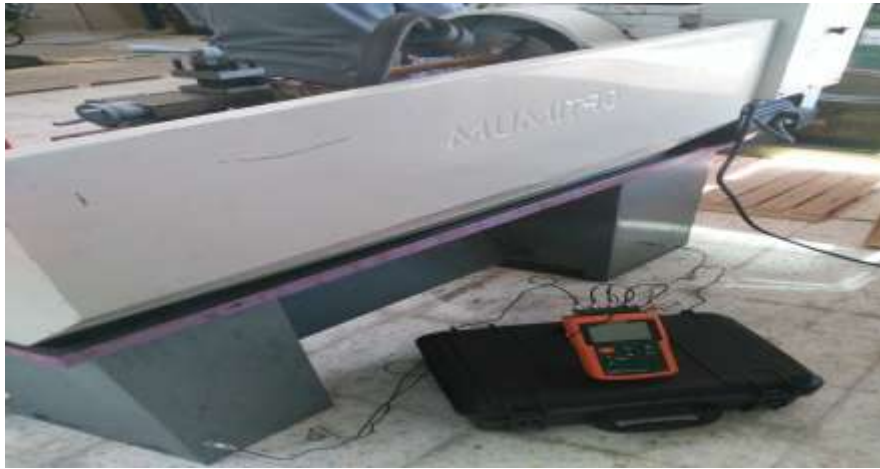
Resim 3.3 Dört kanallı datalogger ve torna tezgâhı.
