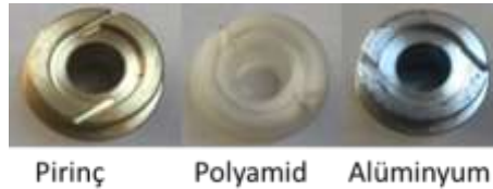
Şekil 2. PZRHVT kullanılan 2 çıkışlı nozullar
