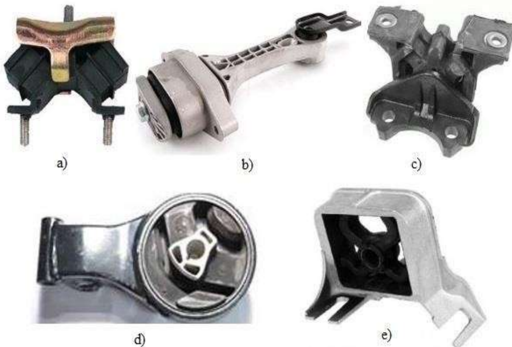
Şekil 2.2 Araçlarda kullanılan bazı kauçuk takoz örnekleri
