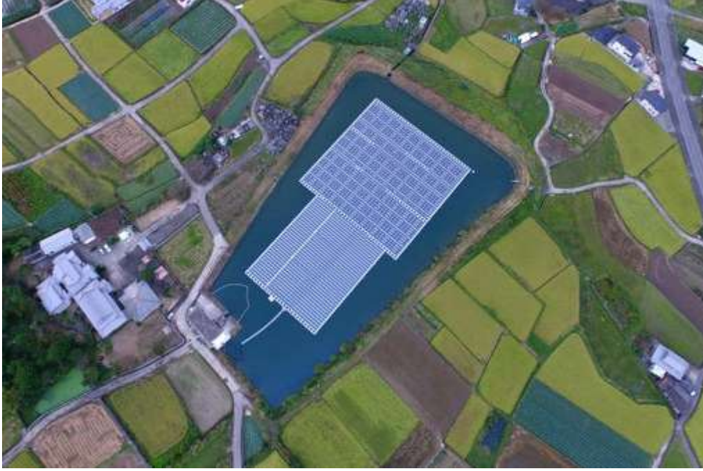
Şekil 1. Su depolama yapılarında buharlaşmayı azaltan gölet üstü GES uygulamaları (Anonim 2024, Anonim 2024a)
