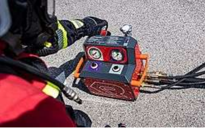
Resim 4: Rfc sistemi Kontrol Paneli
