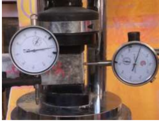
Şekil 2.6. Basınç dayanımı test düzeni
