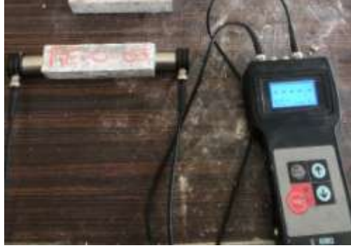
Şekil 1.5. Ultrasonik geçiş hızı ölçüm düzeni
