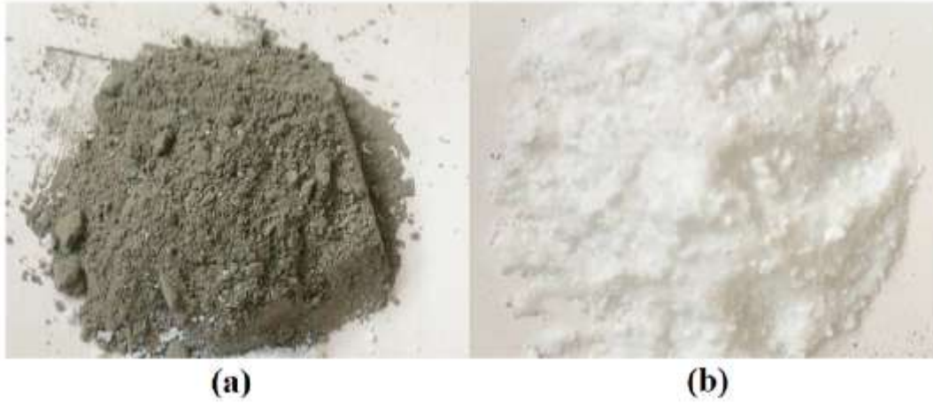
Şekil 1. Kullanılan malzemeler; (a) Portland çimentosu, (b) Nano-silika
