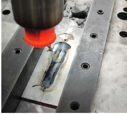
Şekil 8. 1800 rpm Dnş Hızı, 50 mm/dk İlerleme Hızı ile Yapılan Kaynak Ucunun Plastik Deformasyonu
