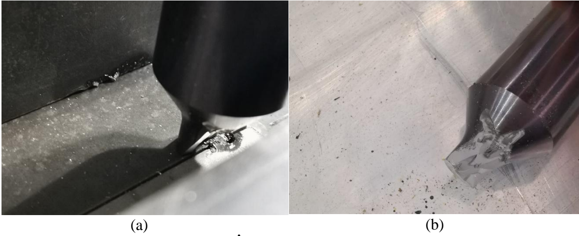
Şekil 5. (a) 200 rpm Dönüş Hızı, 60 mm/dk İlerleme Hızı ile Yapılan Kaynak Başlangıcı ve Kırılma, (b) 200 rpm, 60 mm/sn İlerleme Hızı ile Yapılan Kaynakta Kullanılan Uçun Kırılma Yüzeyi
