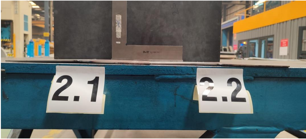
Şekil 6. (2.1) 100 Amper 3 mm/sn İlerleme Hızı- (2.2) 120 Amper 3.2 mm/sn İlerleme Hızı ile Kaynatılmış Parçaların Çarpımları
