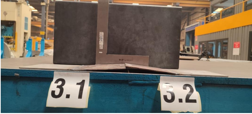
Şekil 7. (3.1) 100 Amper 3 mm/sn İlerleme Hızı 150- 200 C° Ön Isıtılmış ve Perlitte Kontrollü Soğutulmuş- (3.2) 120 Amper 3.2 mm/sn İlerleme Hızı 150- 200 C° Ön Isıtılmış ve Perlitte Kontrollü Soğutulmuş Parçanın Çarpımları
