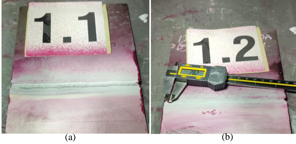
Şekil 9. (a) 1.1 100 Amper 3 mm/sn İlerleme Hızı 150- 200 C° Ön Isıtılmış – (b) 1.2 120 Amper 3.2 mm/sn İlerleme Hızı 150- 200 C° Ön Isıtılmış Parçaların PT Testleri
