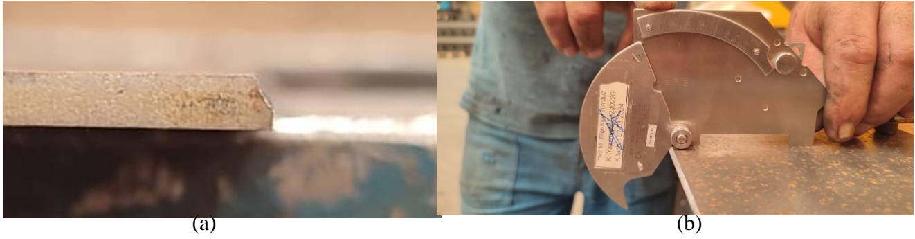
Şekil 10. (a) Kaynak Ağzı, (b) Kaynak Ağzının Kontrolü
