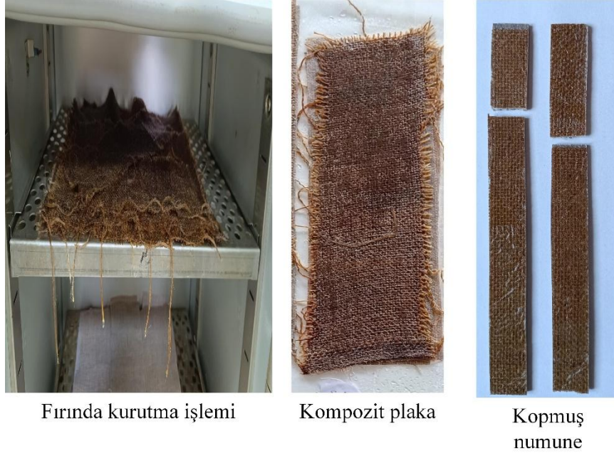
Şekil 1. Kompozit plakaların üretimi ve kopmuş numune
