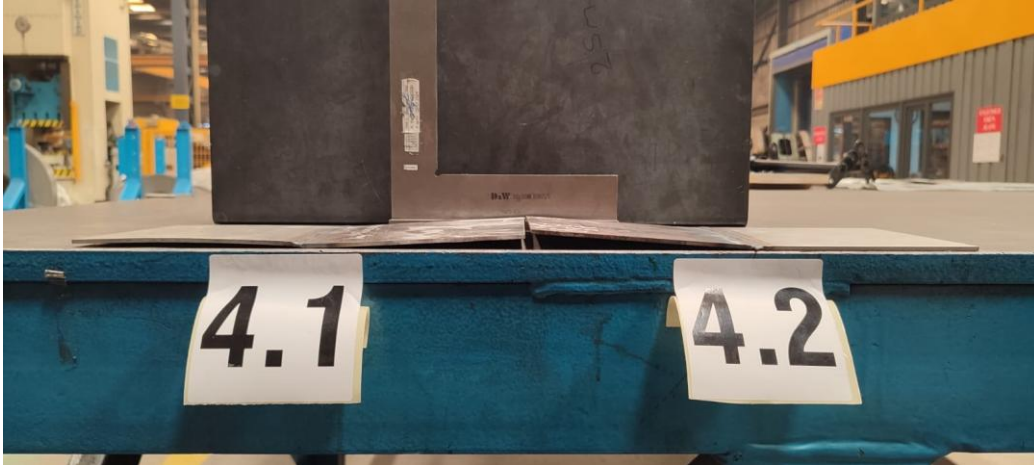
Şekil 8. (4.1) 100 Amper 3 mm/sn İlerleme Hızı Perlitte Kontrollü Soğutulmuş- (4.2) 120 Amper 3.2 mm/sn İlerleme Hızı Perlitte Kontrollü Soğutulmuş Parçanın Çarpımları
