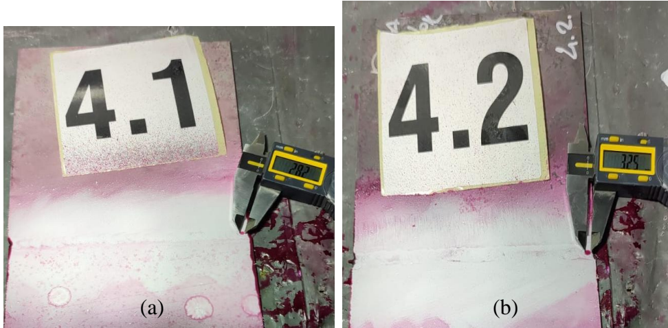
Şekil 12. (a) 4.1 100 Amper 3 mm/sn İlerleme Hızı Perlitte Kontrollü Soğutulmuş- (b) 4.2 120 Amper 3.2 mm/sn İlerleme Hızı Perlitte Kontrollü Soğutulmuş Parçanın PT Testleri
