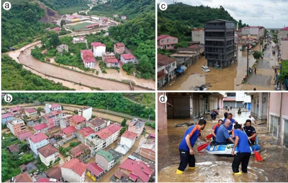
Şekil 3. 10 Temmuz 2023 tarihli Piraziz ilçesi Abdal Deresi taşkınına ait görüntüler (a: Yatağın menderesli olmasına bağlı olarak yukarı bölgedeki ilk kaviste suyun yatağa sığmayarak futbol sahasına ve çevreye taşması ve daha aşağıda yatağın her iki tarafındaki arazilerin su altında kalması, b: Birkaç yüz metre aşağıda Eren Mahallesi'nin su altında kalması, c: Biraz aşağıda şehir merkezinde Eren mahallesi'nin daha yakından durumu, d: Mahsur kalan vatandaşların botlarla kurtarılması, URL-6, 4, 7,8)
