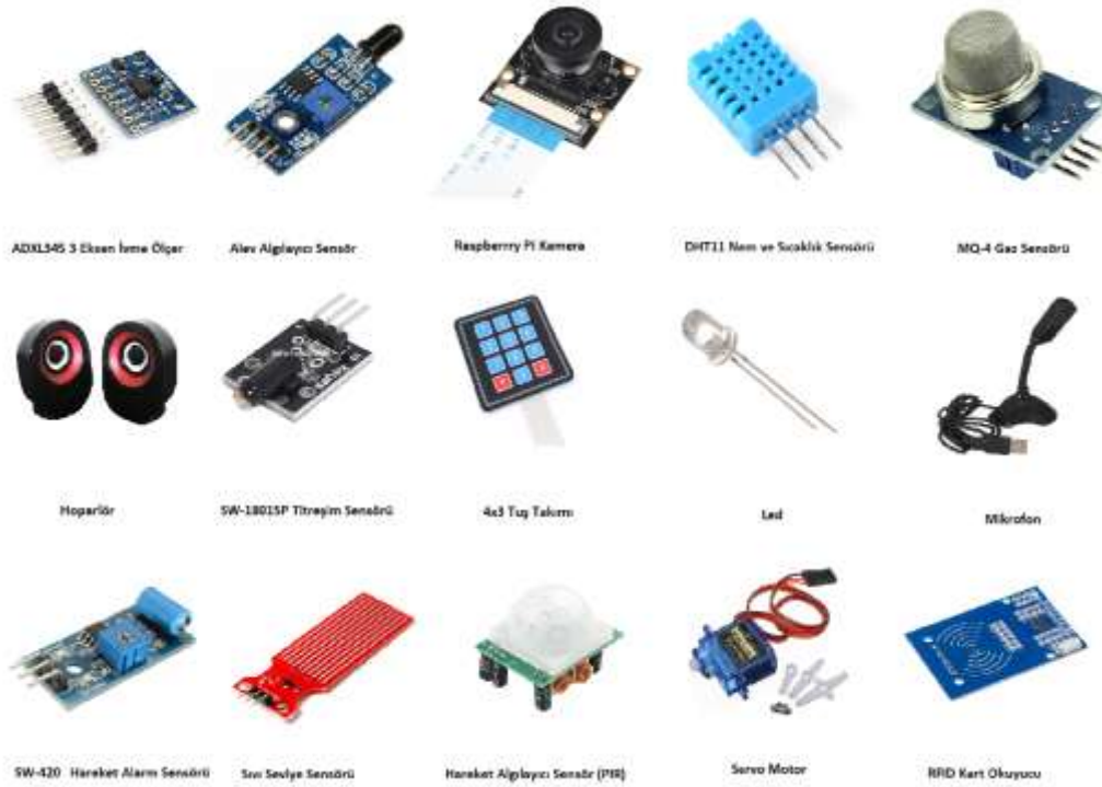
Şekil 2. Raspberry Pi üzerine yerleştirilen donanımsal cihazlar
