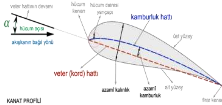
Şekil 2. 1. Airfoil yapısı
